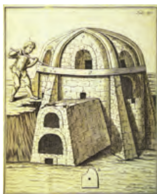
Obr. 8 – Sklářská pec upravená na tavení šmolky, bez chladicí pece, Hasserode-Harz dle J. G. Lehmana, 1750–1760, archiv autora
