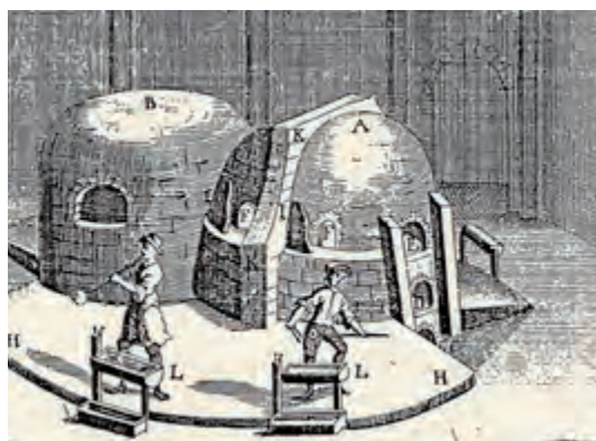
Obr. 6 – Německá sklářská tavicí a chladicí pec podle J. Kuncela, 1756. A – tavicí pec, B – chladicí pec, archiv autora
