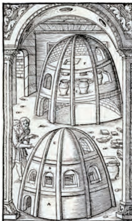
Obr. 4 – Typická benátská tavicí a chladicí sklářská pec dle Agricoly, 1556 (vertikální uspořádání), archiv autora
