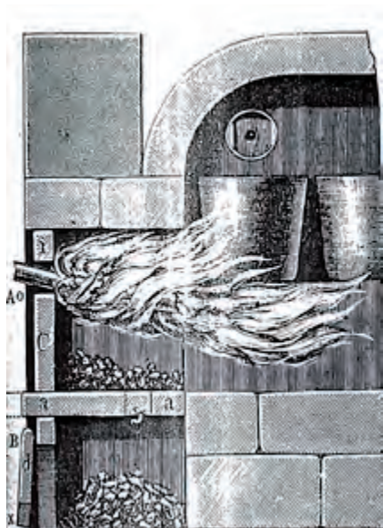
Obr. 11 – Detail topeniště s přímým otopem dřevem (šejty), Meyers Lexikon, 1876, archiv autora
