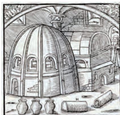
Obr. 5 – Benátská sklářská pec s podélně přisazenou pecí chladicí dle Agricoly, archiv autora
