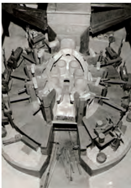
Obr. 12 – Model české sklářské pece, Preitenštejn u Plzně, autor F. Rückl, kolem 1850, SM Kamennický Šenov, foto archiv autora
