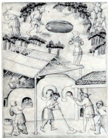
Obr. 3 – Česká sklářská huť s tavicí a chladicí pecí kolem 1420 vyobrazená v Mandevillově rukopisu, archiv autora
